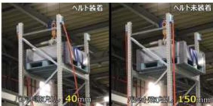
★三進金属工業(株)福島工場内加振試験設備 兵庫県南部地震波形(神戸波)で検証
